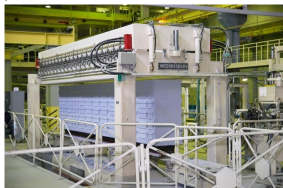
Рис. 2. Линия по производству автоклавного газобетона
